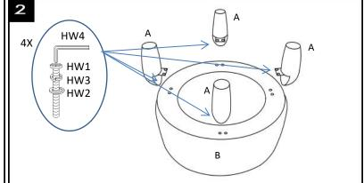
**STEP 2:** PUT THE WASHERS ON THE SCREW IN THE ORDER SHOWN IN THE PICTURE, INSERT THE LEGS AND SCREW IN THE SCREWS BUT DON'T TIGHTEN COMPLETELY. REPEAT THE SAME STEPS FOR THE OTHER THREE LEGS.
