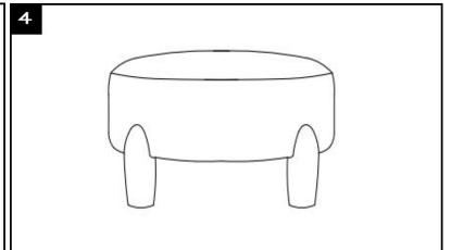
**STEP 4:** PUT THE CHAIR UPRIGHT AND MAKE SURE ALL LEGS ARE LEVEL, THEN FIRMLY TIGHTEN BOLTS WITH ALLEN KEY WHILE THE CHAIR IS UPRIGHT AS PICTURED ABOVE.
