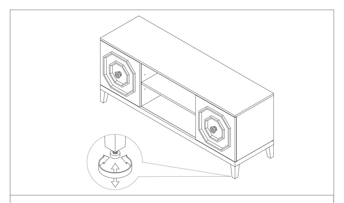
STEP 15 ADJUST THE ADJUSTER THAT HAS ALREADY BEEN ASSEMBLED TO THE LEGS TO STABILIZE YOUR UNIT.
