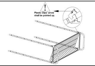
STEP 3: SNAP PLASTIC CLIPS(D) ONTO SAME GROOVES OF POLES. MAKE SURE THAT PLASTIC CLIPS ARE UNDER THE SHOE SHELF.
