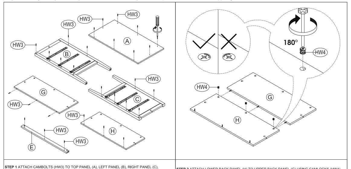
STEP 2 ATTACH LOWER BACK PANEL (H) TO UPPER BACK PANEL (G) USING CAMLOCKS (HW4).
